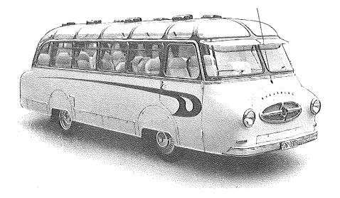
Diesel-Motor · 4 Zylinder · 4-Takt · 85 PS bei 2500 U/min
